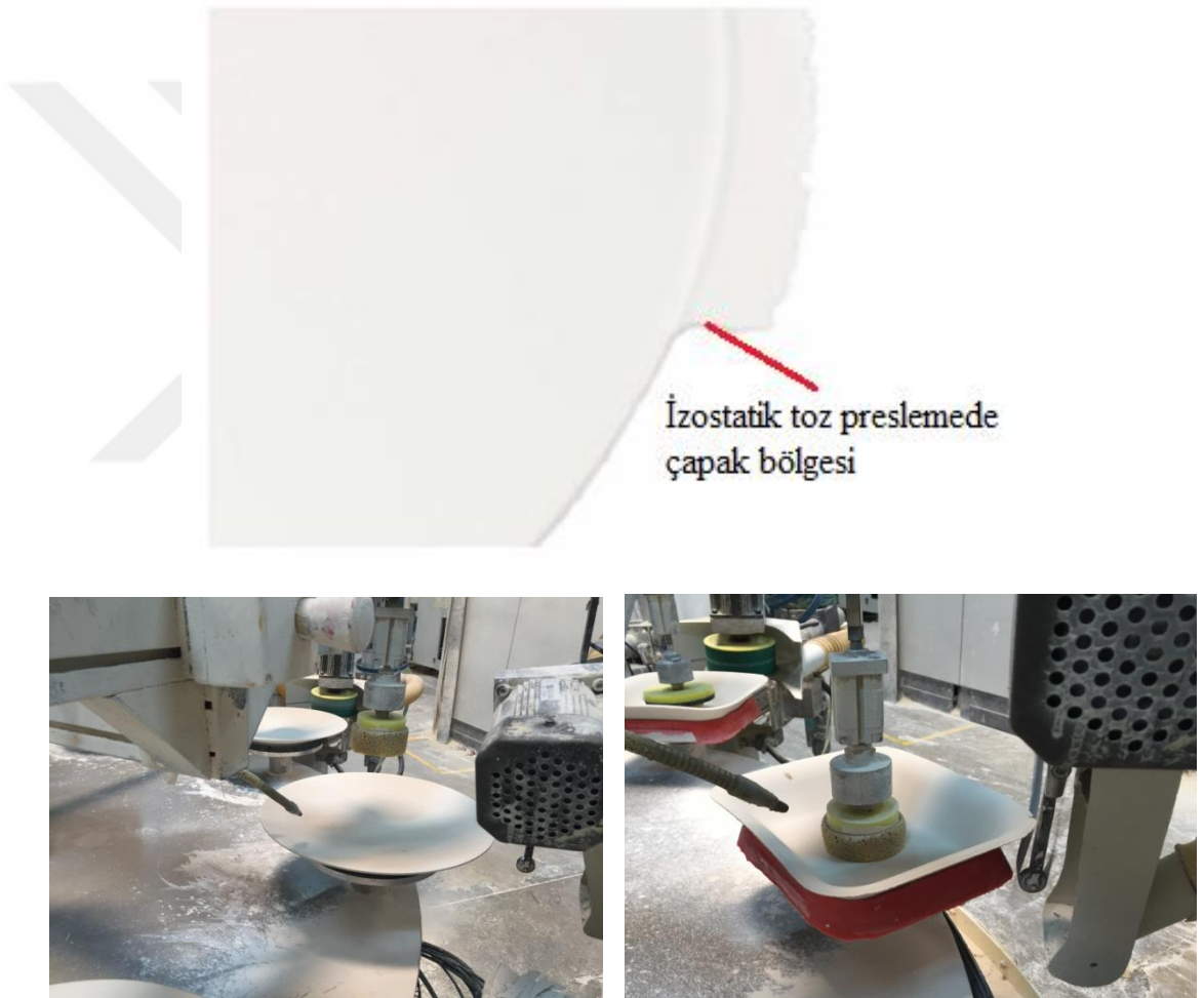
Görsel 5: İzostatik Toz Presleme Rötuşlama Aşamaları
