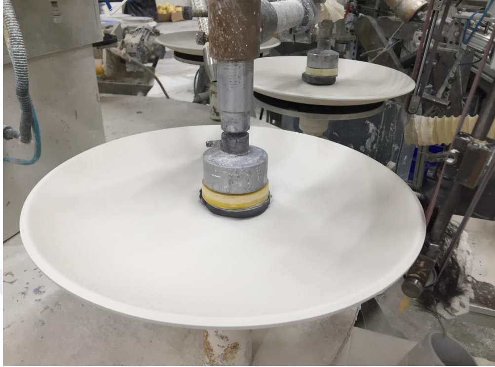
Görsel 59: Deformasyon Giderilme Çalışması Yapılan Mamul
