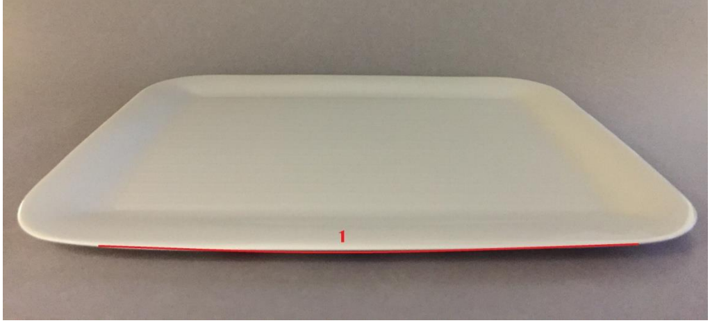
Görsel 50: Deformasyonlu Düz Tabak, Yan Görünüş
