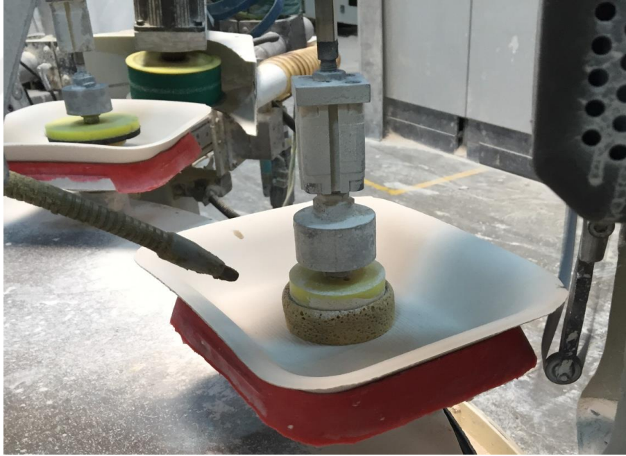
Görsel 63: Çukur Tabak Rötuşlama Aşaması
