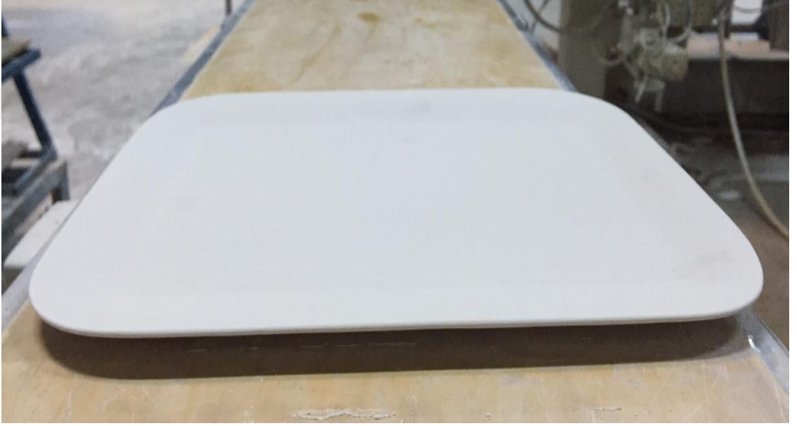
Görsel 55: Deformasyonları Giderilen Tabak, Üst Görünüş
