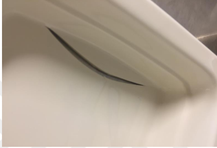
Görsel 34: Basınçlı Döküm Sisteminde Ürün Çatlağı
