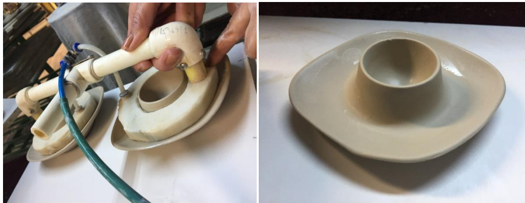
Görsel 40: Vantuz Yardımıyla Mamulün Bırakılması
