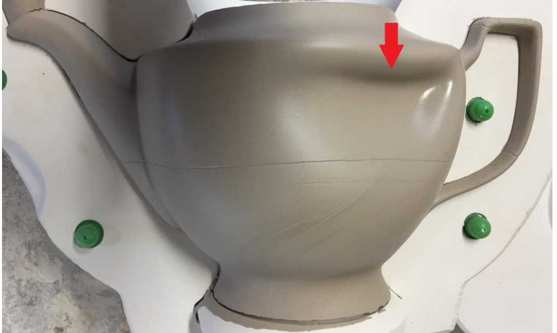
Görsel 38: Mamulün Vakum Yapması Sonucunda Çökmesi
