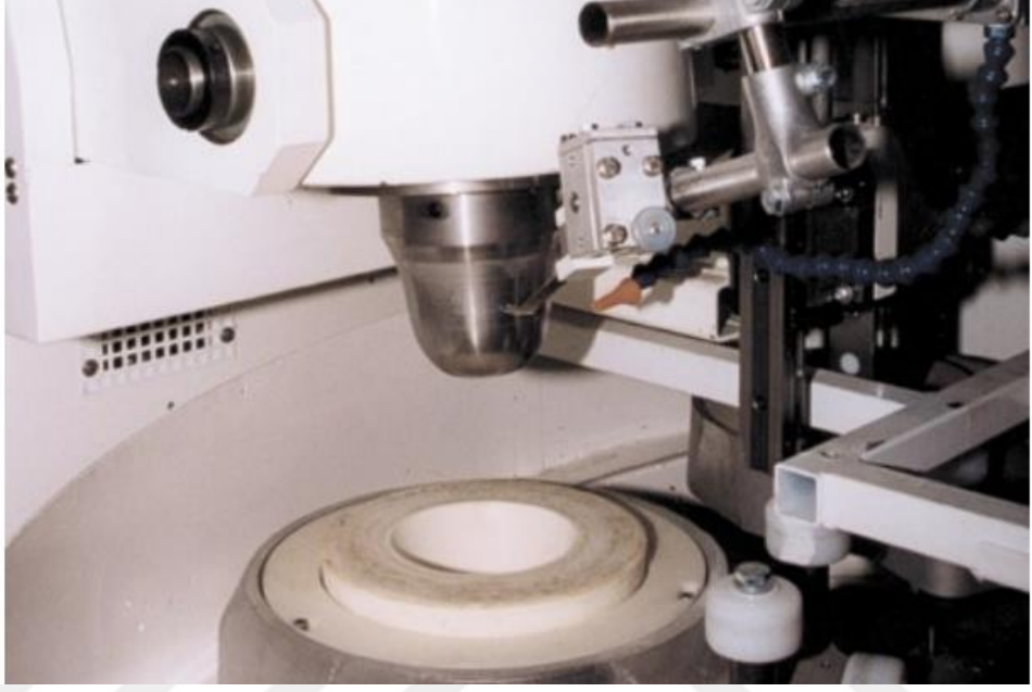
Görsel 6: Plastik Şekillendirme Sisteminde Metal Şablon
