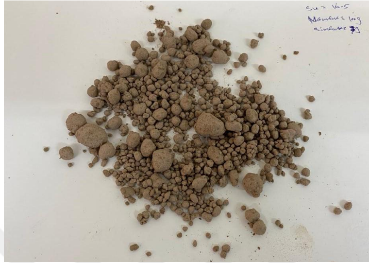
Şekil 6. 8. 7 g çimento 100 g numune üzerinde gerçekleştirilen aglomerasyon sonuçları.
