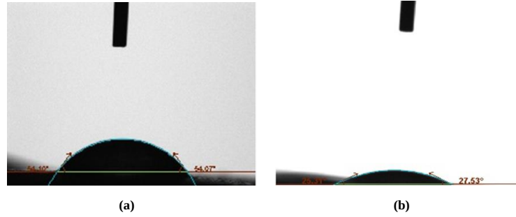
Şekil 7.2. Filmlerin yüzey temas açısı görüntüleri ve değerleri. (a) film (b) eksfoliye film
