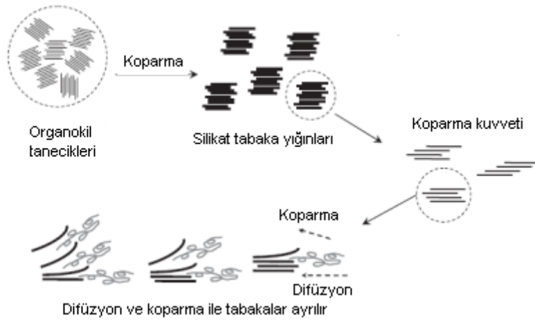
Şekil 3.16. Eriyik işleme sırasında organokil dağılımının ve eksfoliasyonun mekanizması
