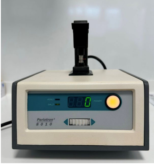
Şekil 3.3. DOS hacmini ölçmek için Periotron 8010 cihazının kalibrasyonu ve kağıt striplerin cihaza yerleştirilip DOS hacminin hesaplanması
