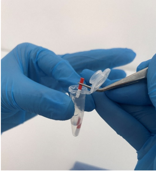
Şekil 3.4. Alınan örneklerin analiz gününe kadar saklanmak üzere eppendorf tüpüne konulması
