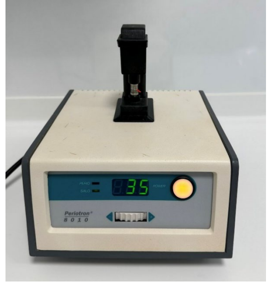
Şekil 3.3. DOS hacmini ölçmek için Periotron 8010 cihazının kalibrasyonu ve kağıt striplerin cihaza yerleştirilip DOS hacminin hesaplanması
