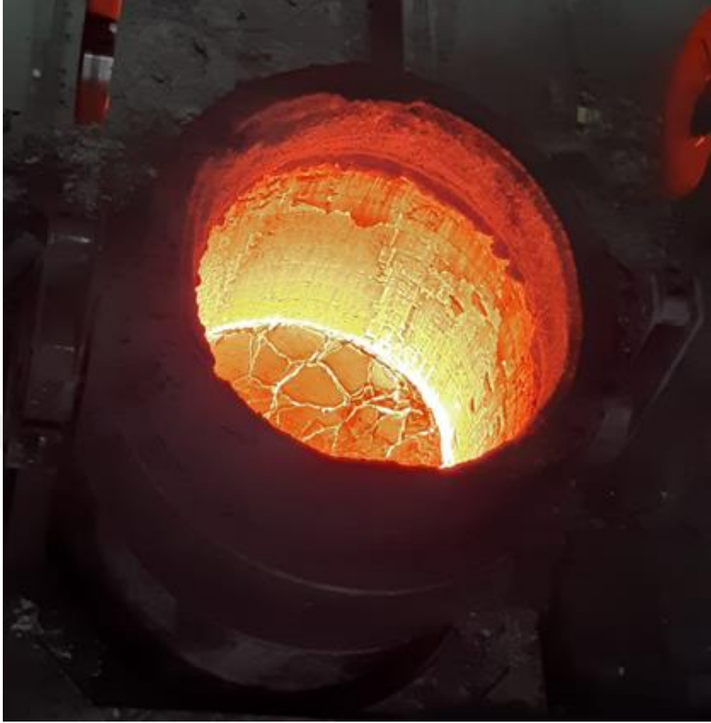
Şekil 3.13. Pota İçerisinde Cüruf - Çelik Bölgeleri [8].
