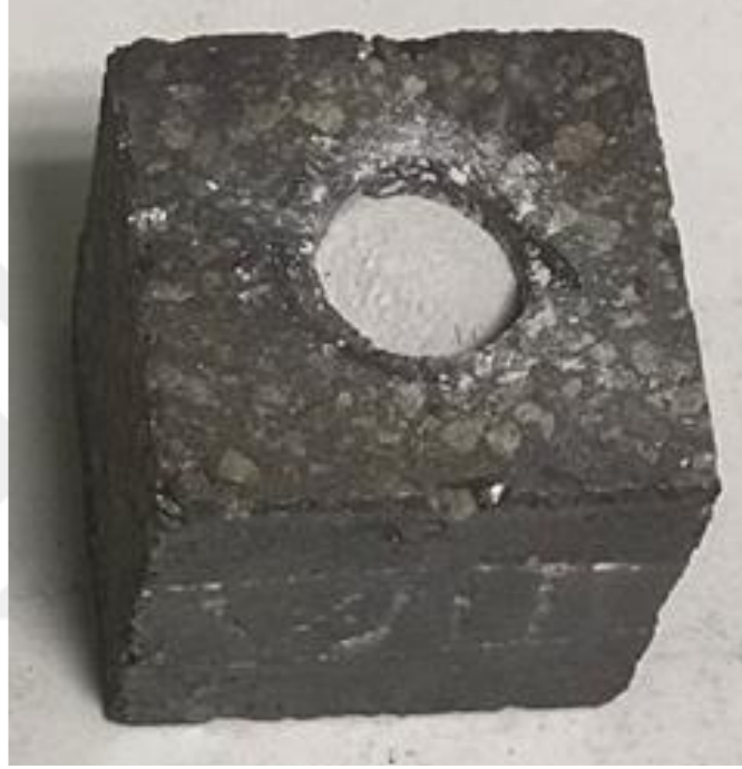
Şekil 4.7. 5x5x5 cm ebatlarında cüruf konulan kroze görüntüsü
