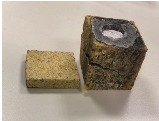
Şekil 5.4. Isıl işlem sonrası çatlama görülen numune
