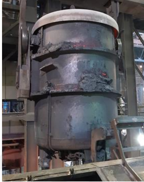
Şekil 3.5. Çelik Üretim Potası Transferi [8].
