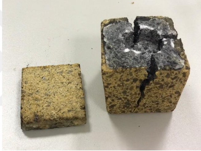
Şekil 5.3. Isıl işlem sonrası kırılma görülen numune
