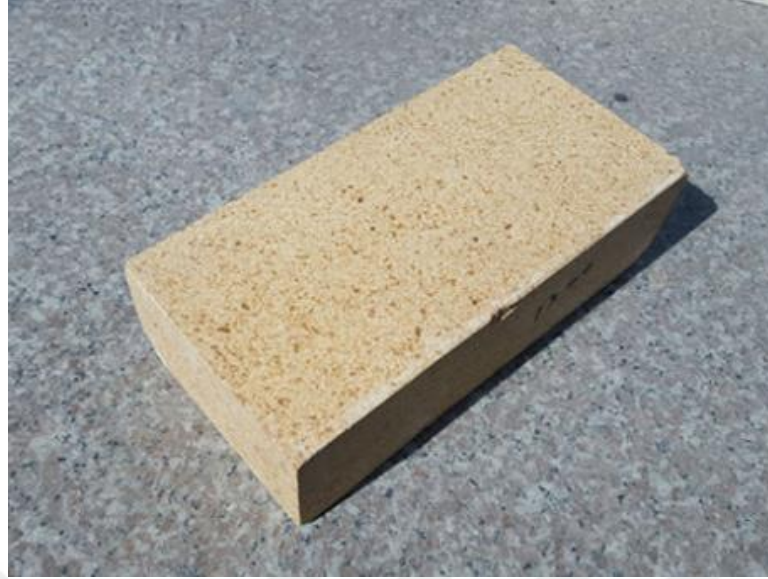
Şekil 3.11. Dolomit Refrakter Tuğla [19].
