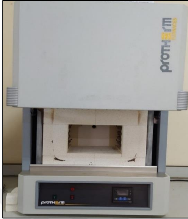
Şekil 4.5: Klorürleyici kavurmada kullanılan kamaralı fırın görüntüsü.
