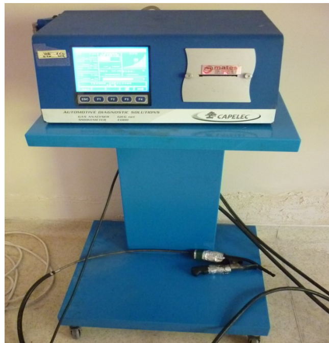
Şekil 5. 8.Capalec Cap 3200 Kombi marka egzoz gaz analiz cihaz görüntüsü
