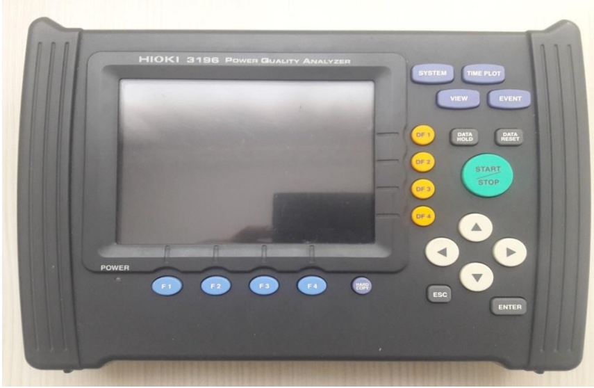
Şekil 2.2. Hioki 3196 güç kalitesi ölçüm cihazı
