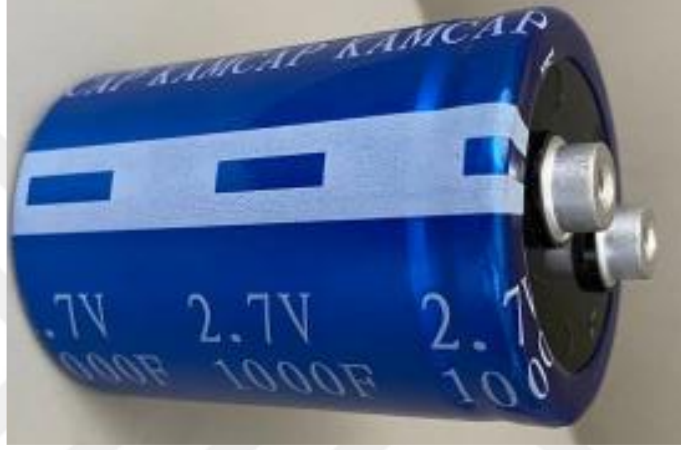
Şekil 2.37. KAMCAP HP-2R7-J108UNJ47 model süperkapasitör
