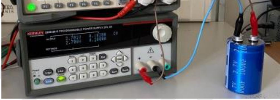
Şekil 2.39. Süperkapasitör hücresinin şarj edilmesi
