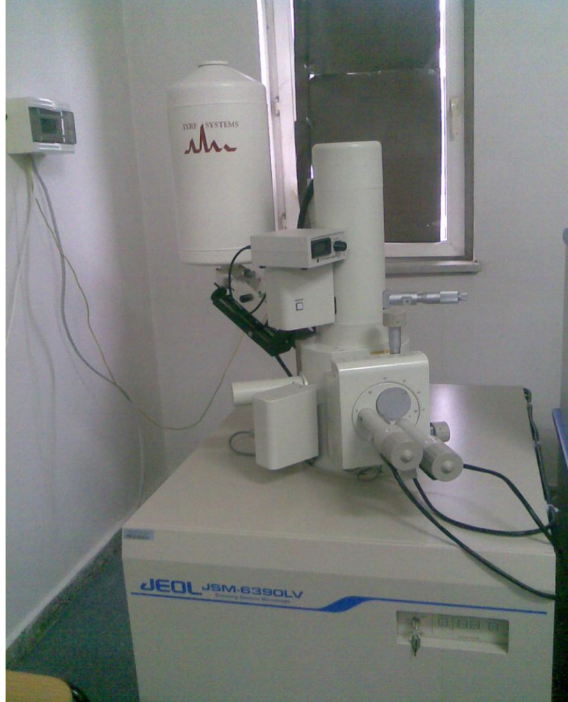
Şekil 2.6 JEOL JSM-6390LV Taramalı Elektron Mikroskobu
