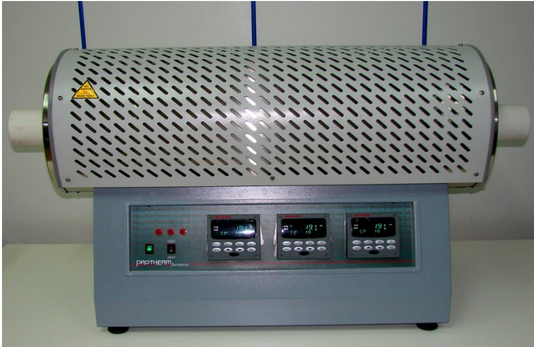
Şekil 2.4 PROTHERM programlanabilir tüp fırın
