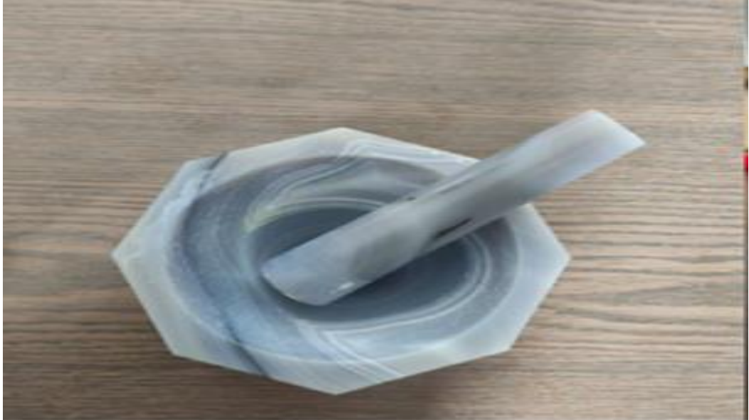
Şekil 3.4. \text{Bi}_{2.0-x}\text{Pr}_x\text{Sr}_{2.0}\text{Ca}_{1.1}\text{Cu}_{2.0}\text{O}_y seramik materyal üretiminde kullanılan seramik havan ve tokmak
