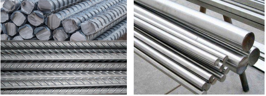
Şekil 3.1. Düz donatı çeliği ve nervürlü donatı çeliği (URL 13)
