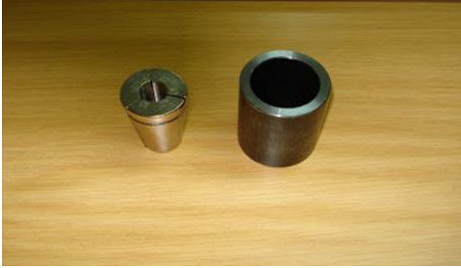
Şekil 1.23. Öngerme işleminde kullanılan halatı tutan konik parçalar
