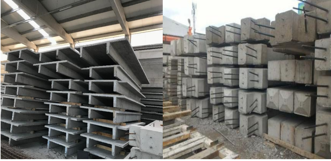
Şekil 1.32. Prefabrik Yapı Elemanlarının Stoklanması
