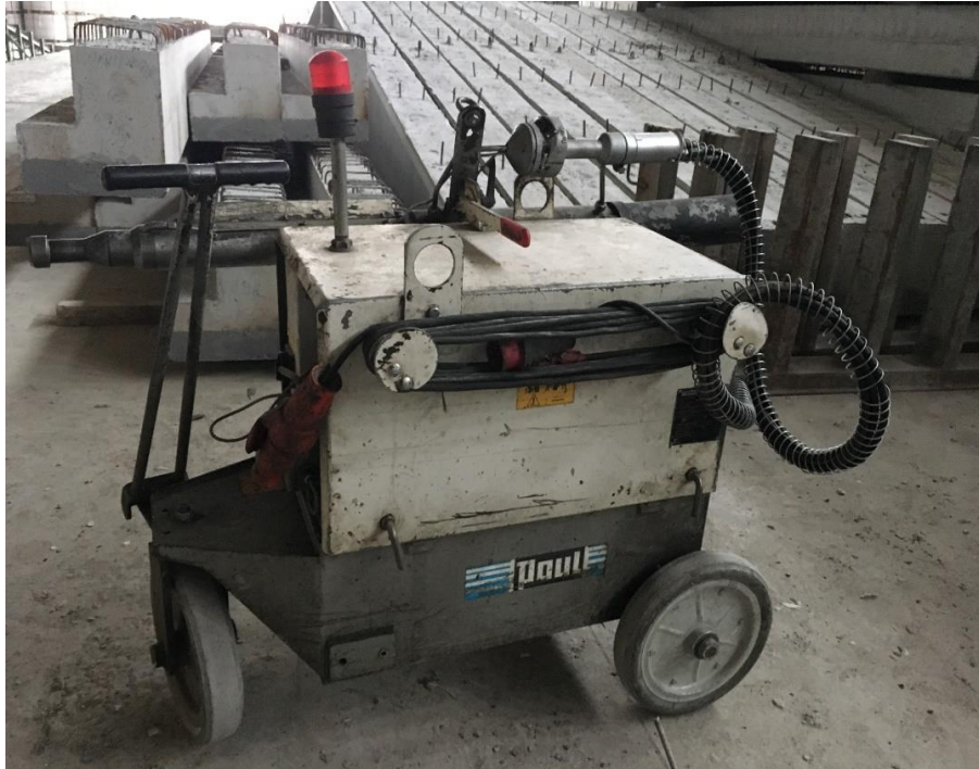
Şekil 1.24. Öngerme işleminde kullanılan hidrolik ünite
