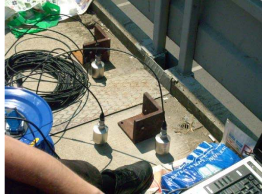
b. y ve z doğrultusunda yerleştirilen ivmeölçerler ve referans
