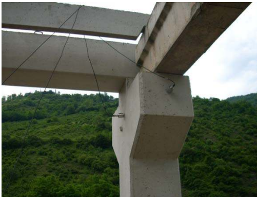
Şekil 2.16. Üretim tesisinin çerçeveleri üzerine yerleştirilen ivmeölçerlerin yerleşim düzeni
