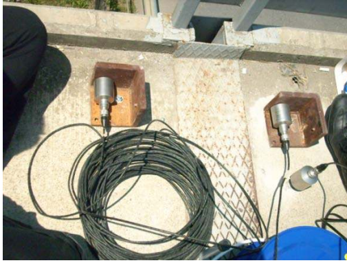
b. y ve z doğrultusunda yerleştirilen ivmeölçerler ve referans
