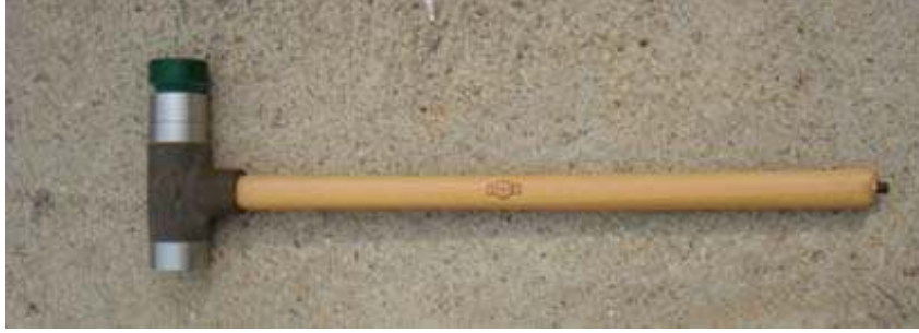
Şekil 1.22. B&K tipi darbe çekici örneği
