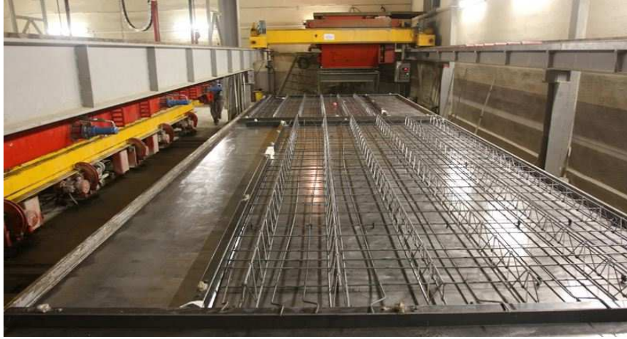
Şekil 3.8 Prefabrik Filigran Döşeme Donatı Yerleşimi [18]
