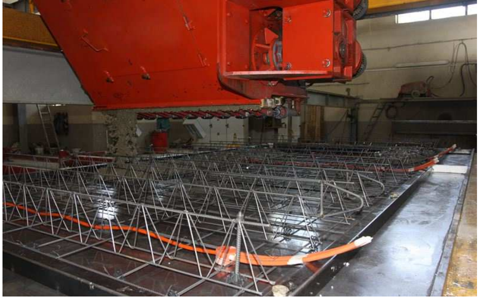
Şekil 3.4 Prefabrik Çift Duvar Eleman Donatı Yerleşimi [18]
