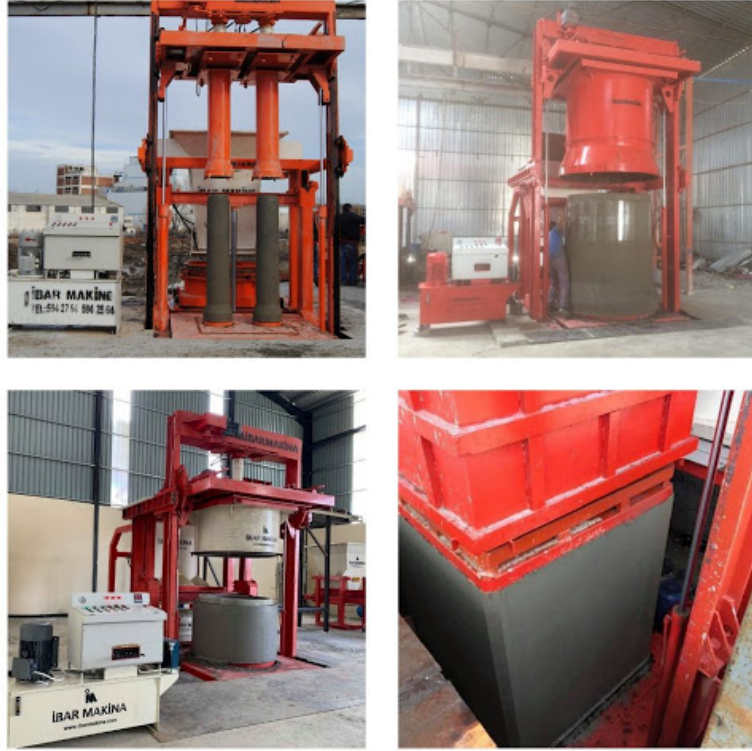
Şekil 2.7 Prefabrik Menfez Üretimi [20]
