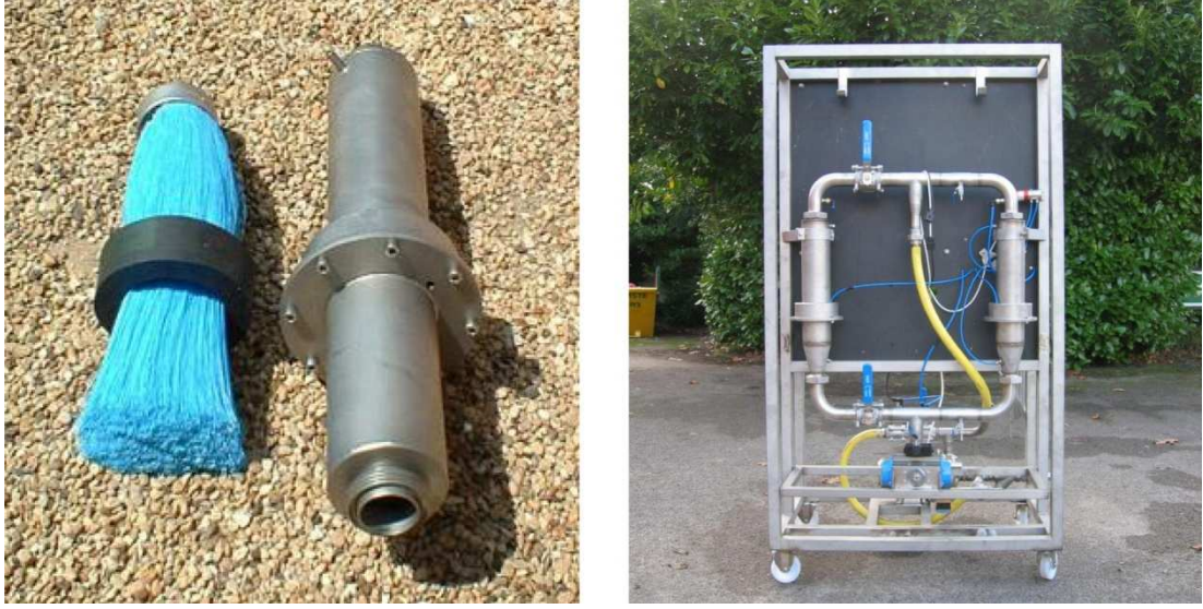
Resim 3.9. Fibrer-filtrer filtrleme sistemi ve paralel baęlanmıř ikili arıtma sistemi [Graham, 2004].
