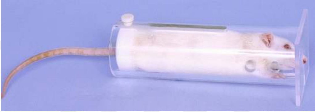
Şekil 3. Sıçan immobilizasyon aparatı (54)
