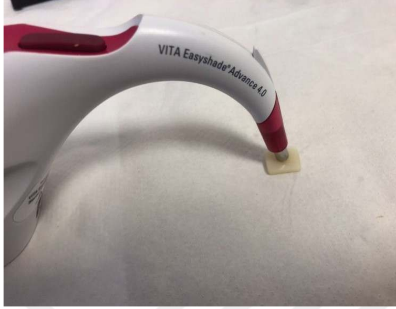
Şekil 3.16 Spektrofometre ile renk ölçümü.
