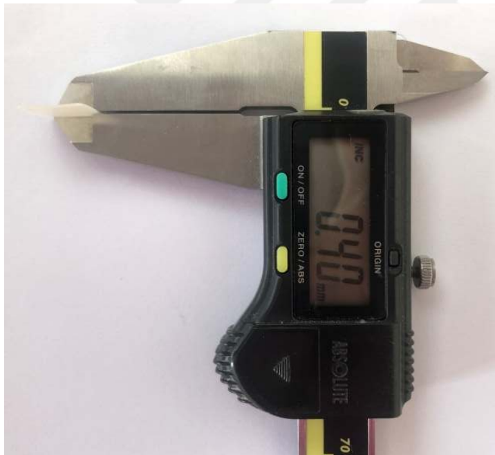
Şekil 3.8. Absolute elektronik kumpas
