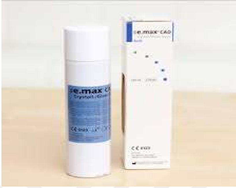
Şekil 3.10 Seramik örneklerinin glazürlenmesi için kullanılan glazür spreyleri.
