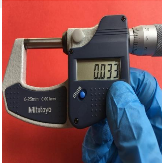
Şekil 4.9. P. caudatus 'tan izole edilen kitin filmlerin dijital mikrometre ile ölçümü.
