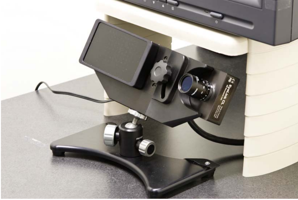
Şekil 3-4: Eyelink 1000 masaüstü yerleşimli göz takip (eye-tracking) sistemi.
