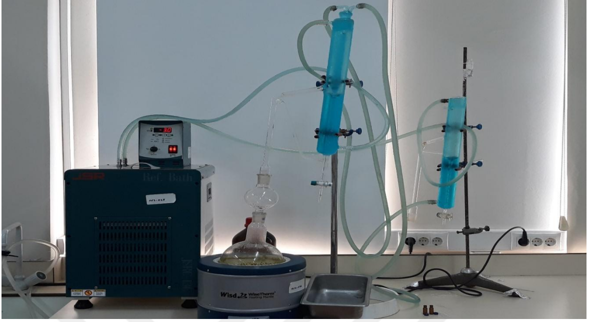
Şekil 2.3. Çalışmada kullanılan Clevenger düzeneği
