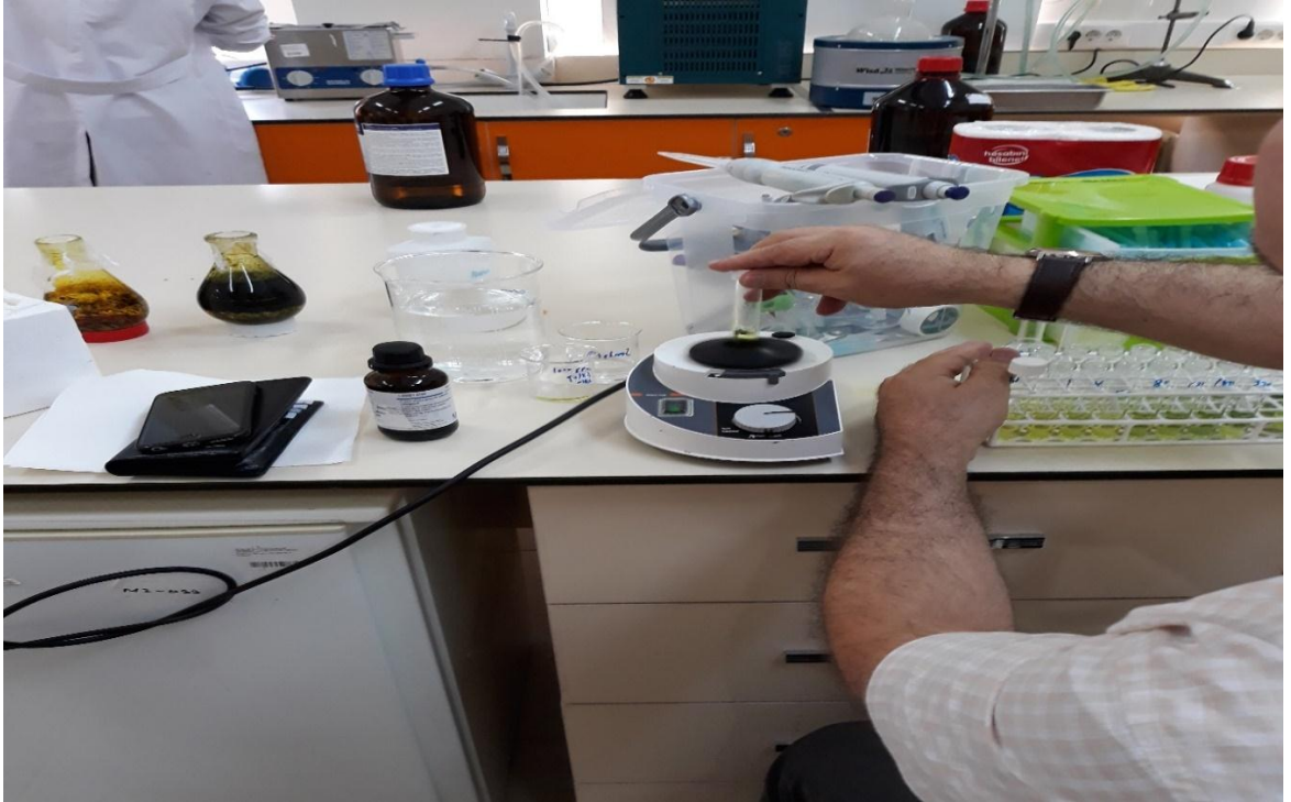
Şekil 2.16. Örneklerin antioksidan madde tayini için vortekslenmesi
