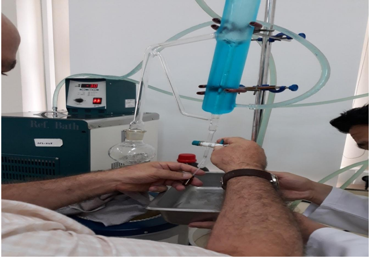
Şekil 2.4. Toplanan uçucu yağların renkli şişelere (vial) konulması
