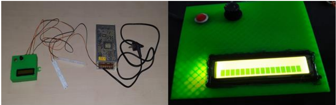
Resim 16. Yanıp sönen ışık (300 kez/dk): Elektronik yazılımla hazırlanan, sıçanları irrite edecek yüksek parlaklığa sahip lambaların kullanıldığı, dakikada 300 defa yanıp sönen ve istenilen saat aralığında çalışmak üzere programlanabilen düzenek kullanıldı.
