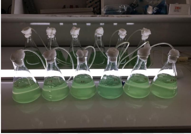
Şekil 2.4. 40 °C’de 1600 lux aydınlatmada kùltüre alınan S. platensis .
