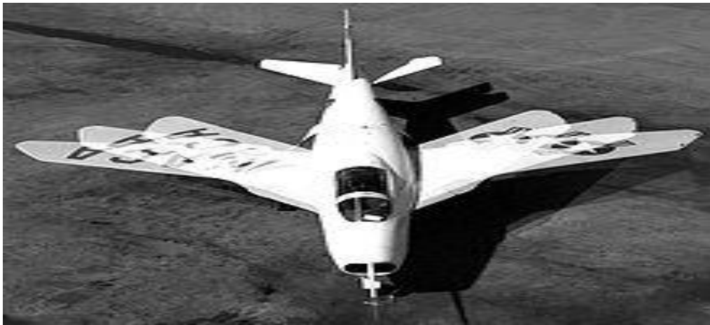
Şekil 3.2. Bell X-5 Ait farklı kanat süpürme açıları
