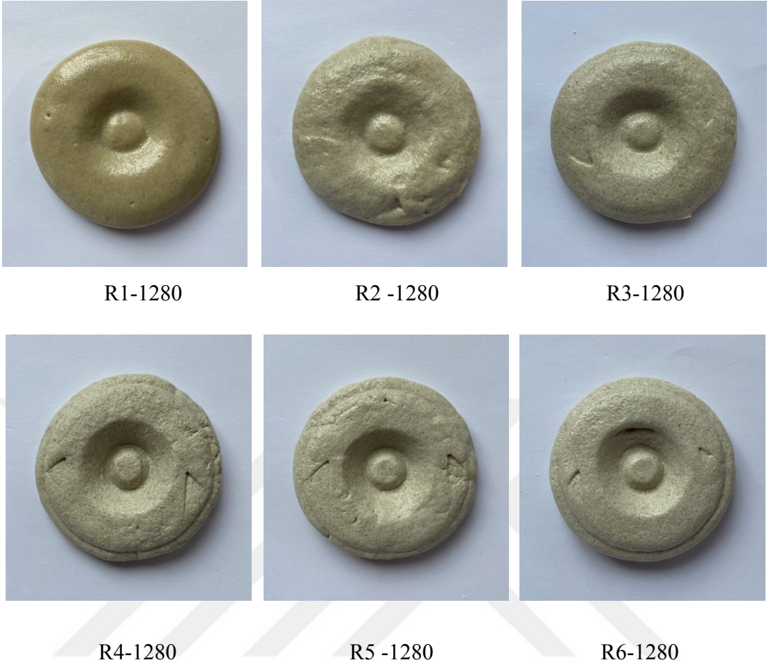
Görsel 3.6. Üçlü sistemde Profillit, Ukrayna Kili ve Feldspat ile oluşturulan bünyelerin 1280 °C'deki değişimleri
