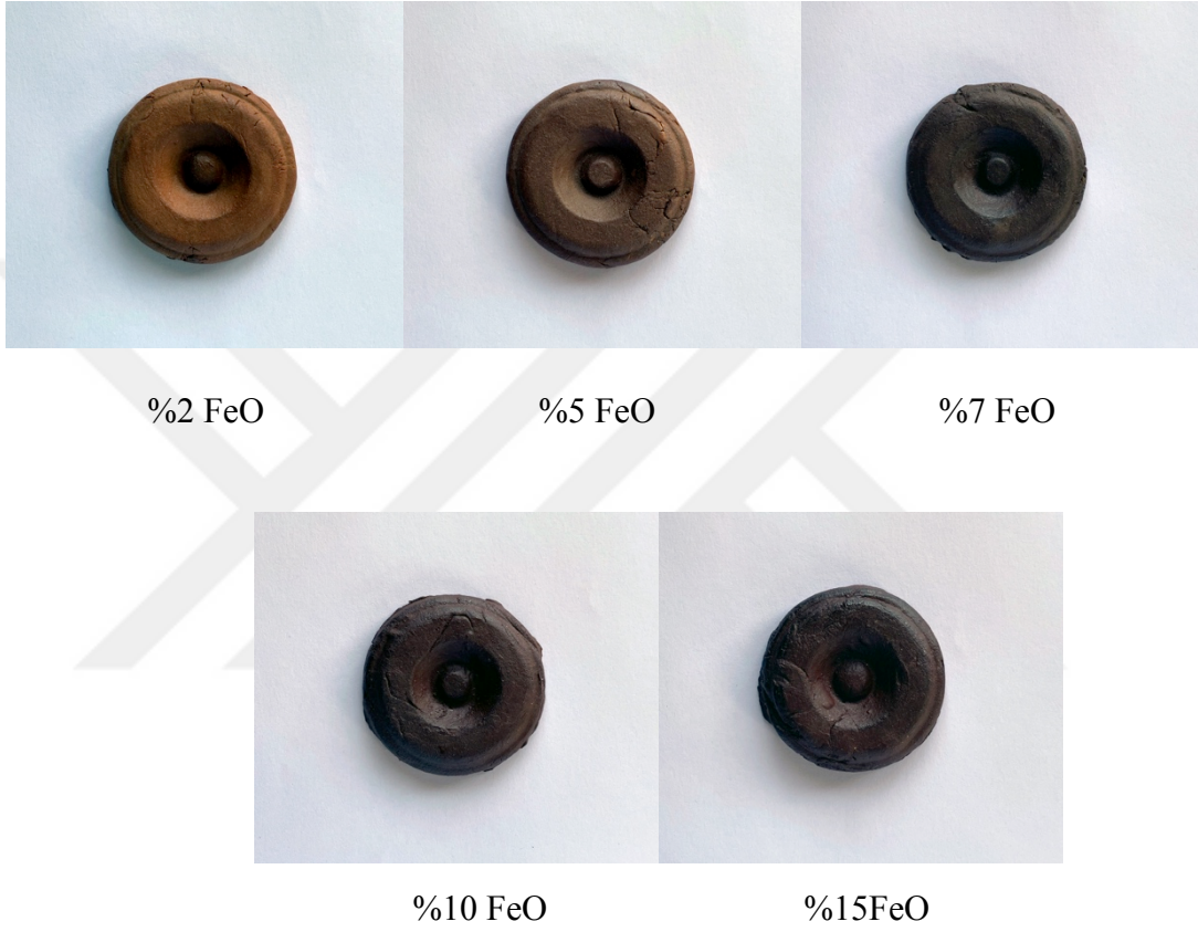
Görsel 3.18. FeO katkılı bünyelerin pişirim renkleri 1280 °C
