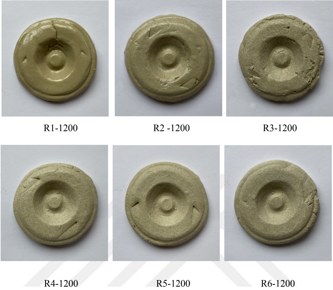
Görsel 3.5. Üçlü sistemde Profilit, Ukrayna Kili ve Feldspat ile oluşturulan bünyelerin 1200 °C'deki değişimleri
