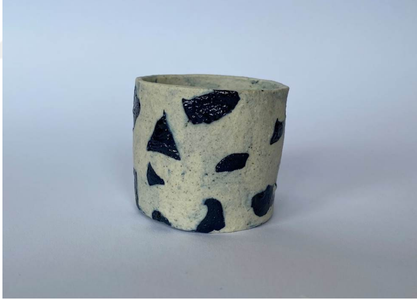
Görsel 3.25. R24 numaralı reçete ve %5 krom oksit katkılı çamur ile hazırlanmış elle şekillendirme yöntemiyle uygulanan form(1280°C) 6cm x 6cm
