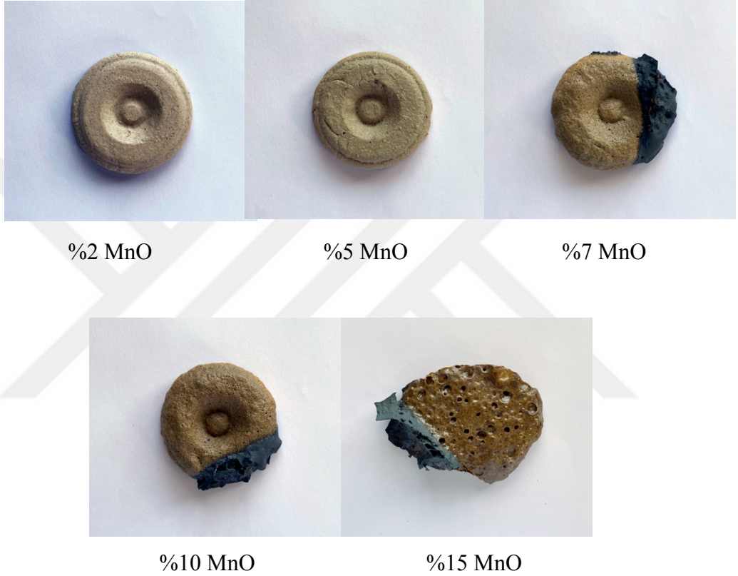
Görsel 3.21. MnO katkılı bünyelerin pişirim renkleri 1280 °C
