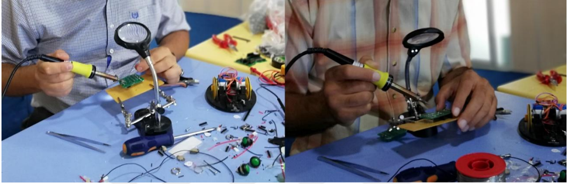
Resim 4.9 PCB kart üzerine diğer elektronik parçaların lehimlenmesine ilişkin görsel.
