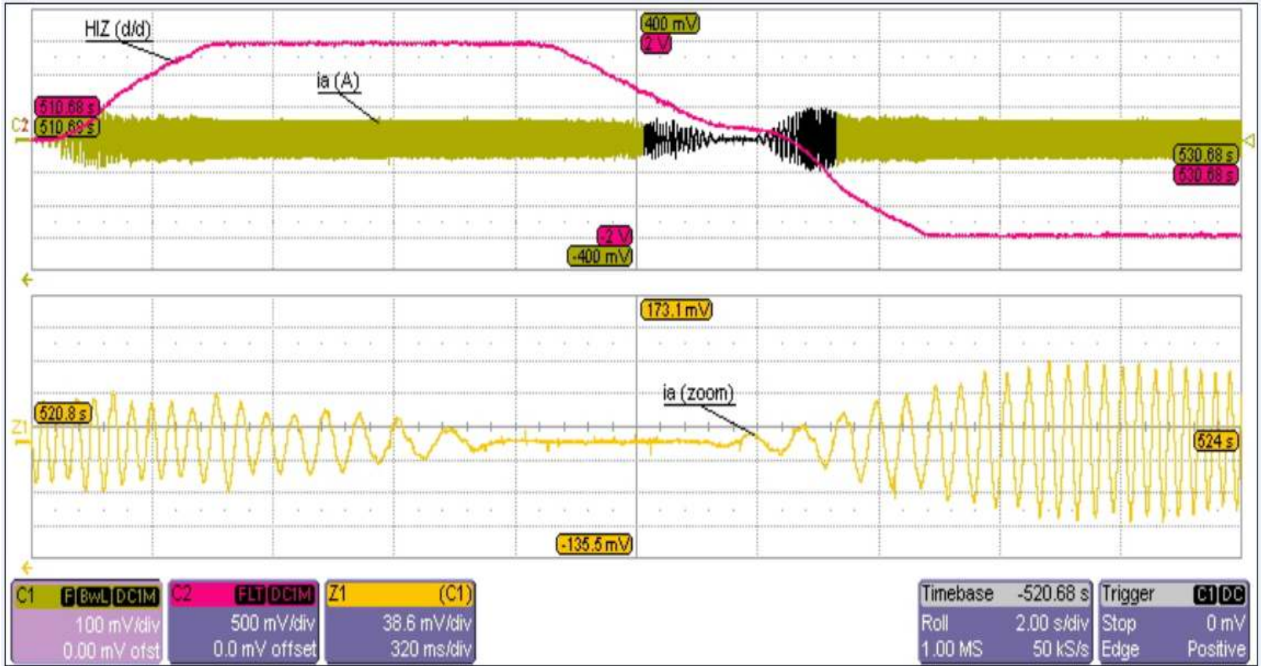
Şekil 6.24. Motorun Yön Değişimi Sırasında I_a Akımı ( f=50\text{Hz} )
