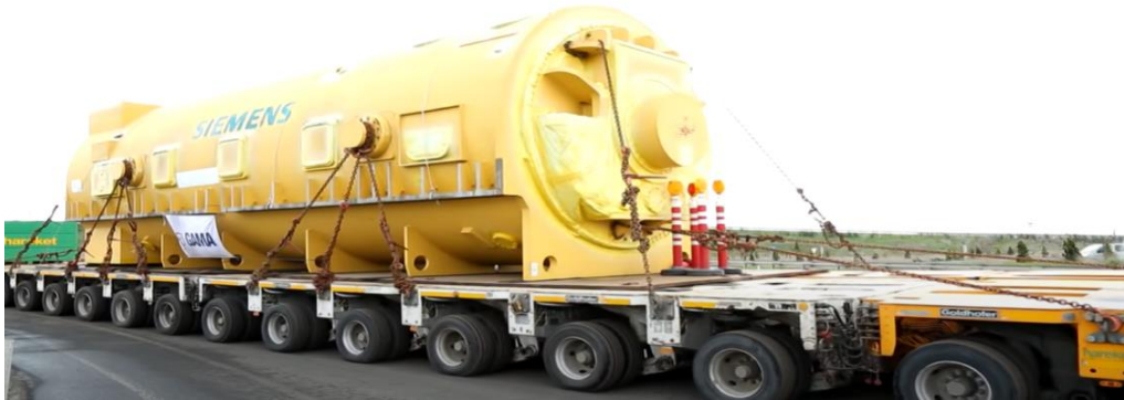
Şekil 2.31: 450 tonluk jeneratörün taşınması
