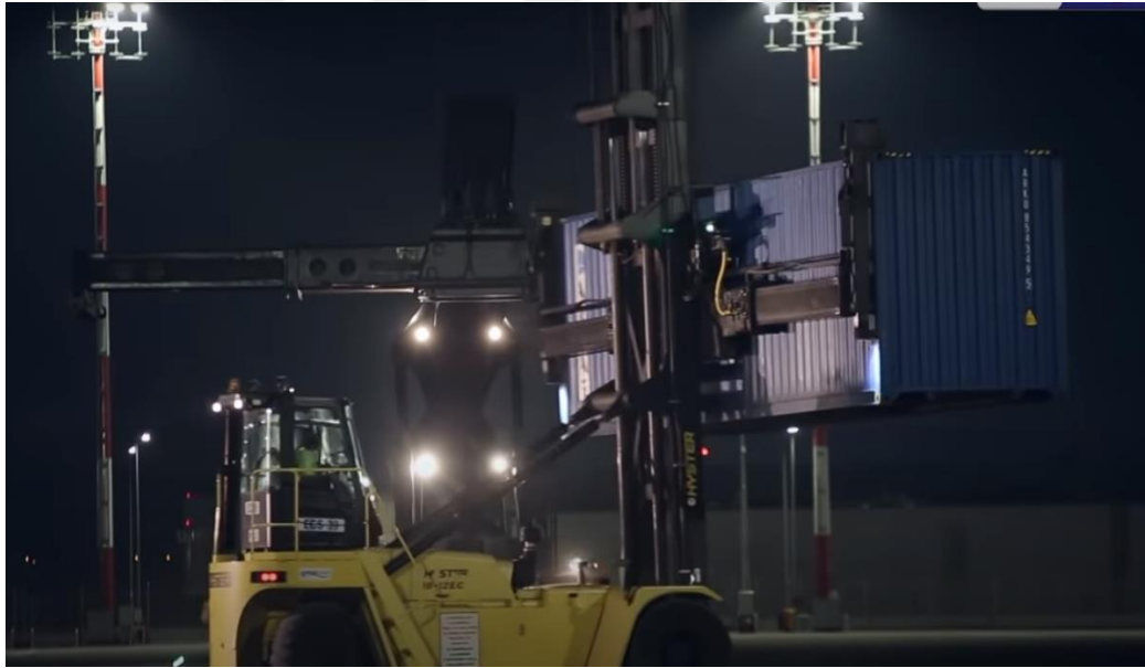
Şekil 2.33: Havalimanı ekipmanlarının konteyner ile taşıma araçlarına yüklenmesi
