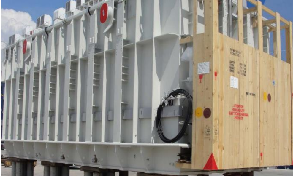
Şekil 2.8: 285 tonluk elektrik trafosu
