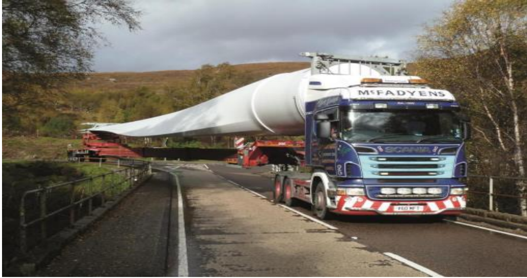
Şekil 3.17: Rüzgâr kanadının karayolu taşımacılığı ile transferindeki köprü geçişi
