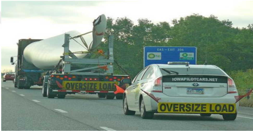
Şekil 3.9: Türbin kanatlarının taşınması sırasındaki koruma aracı
