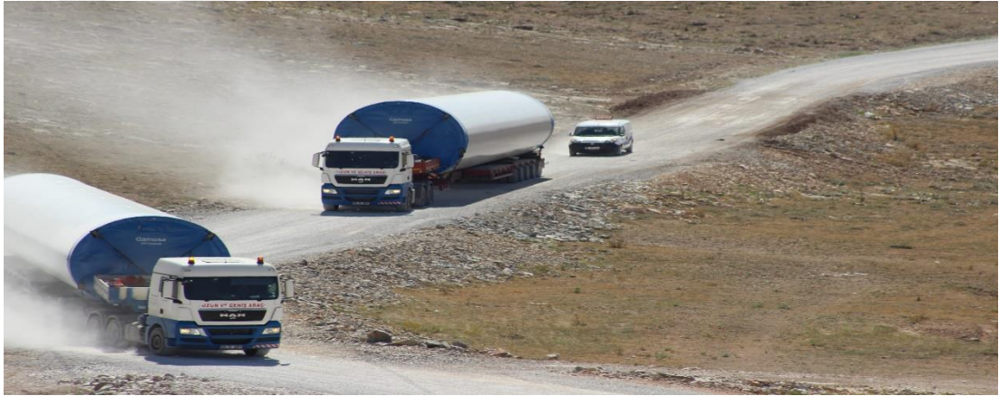
Şekil 3.8: Kule parçalarının alana getirilmesi
