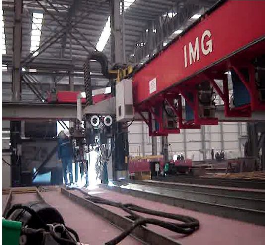
Şekil 7.10.1a : Panel hattı kaynak makinaları
