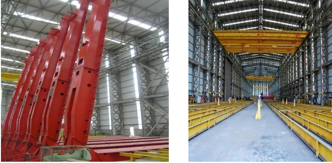
Şekil 7.10.1b : Panel çevirme sistemi ve üretim hattı
