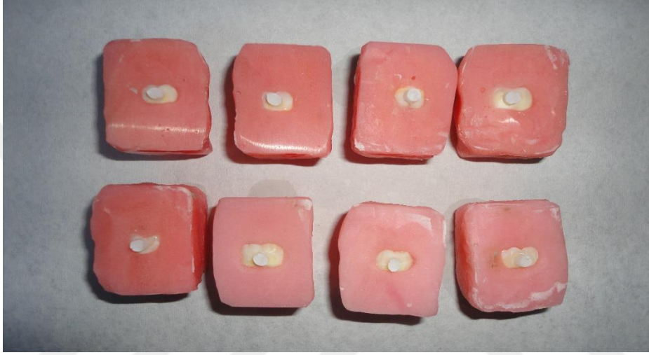
Şekil 3.11. Akrilik bloklar içine gömülen dişler
