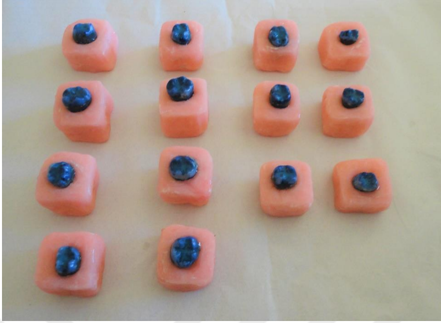
Şekil 3.17. Akrilik reçine içerisine gömülen dişler
