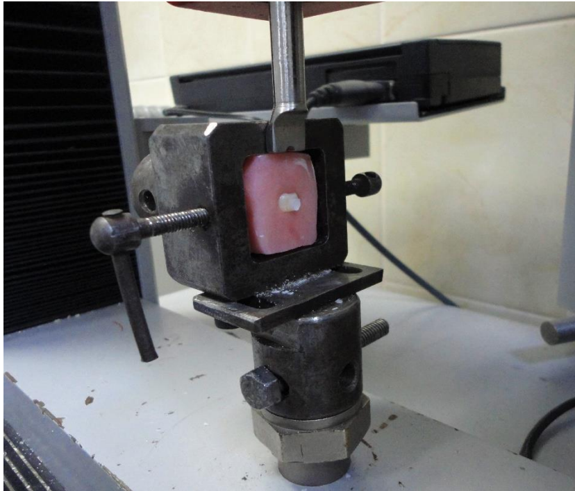
Şekil 3.12. Testometric cihazına yerleştirilen diş örneği
