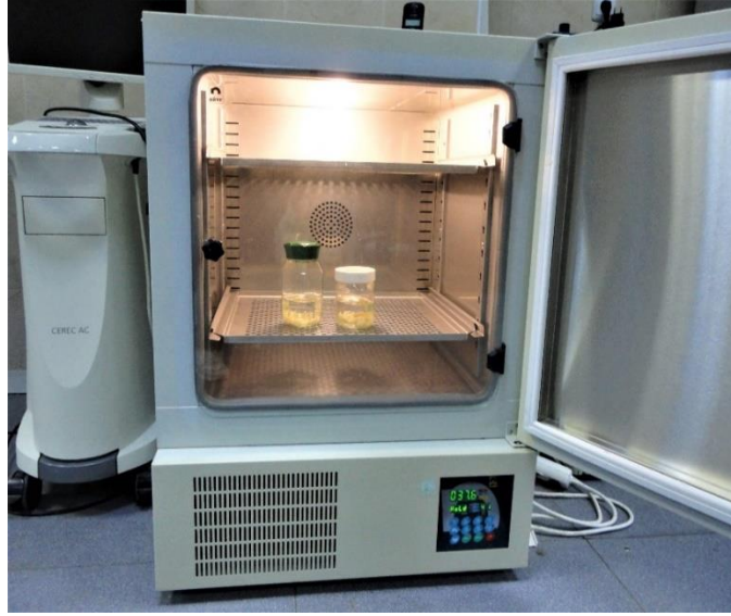
Şekil 3.13. Dişlerin distile suda 37°C'de 24 saat süreyle bekletilmesi
