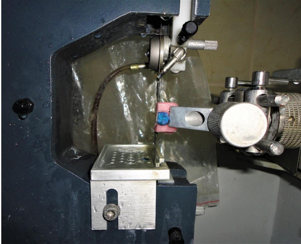
Şekil 3.18. Kesit alma cihazına yerleştirilen örnek
