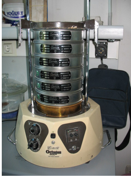
Şekil 6.1 Titreşimli elek cihazı ve eleklerin yerleşiminin şematik görünümü.
