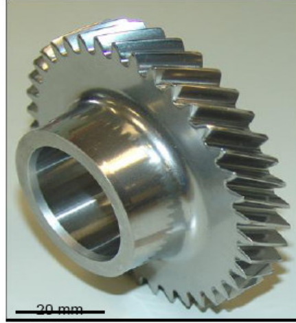
Şekil 5.4 Yüzeyi yoğunlaştırılmış T/M bir helisel dişli (Sözen, 2006)
