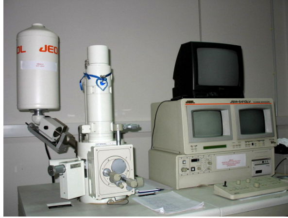
Şekil 6.3 Tarama elektron mikroskobu (JEOL 5410 LV)
