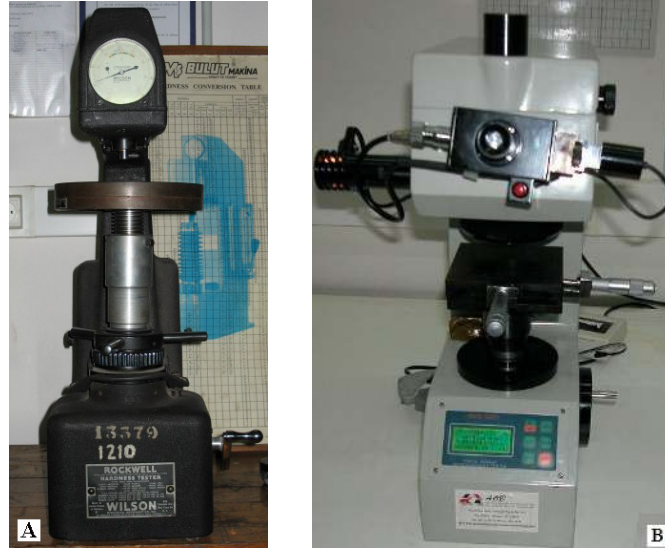
Şekil 6.10 A) Rockwell sertlik cihazı B) Mikrovickers sertlik cihazı
