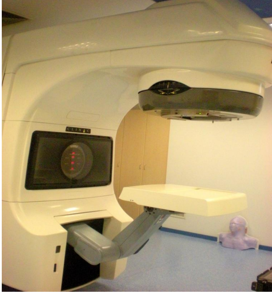
Şekil 3.9. Varian marka Clinac DBX 2100C düşük enerjili ( 6 MV ) lineer hızlandırıcı tedavi cihazının EPID ( Elektronik Portal Görüntüleme) sistemi
