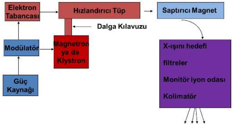
Şekil 2.6 : Lineer hızlandırıcının çalışma prensibinin şematik gösterimi
