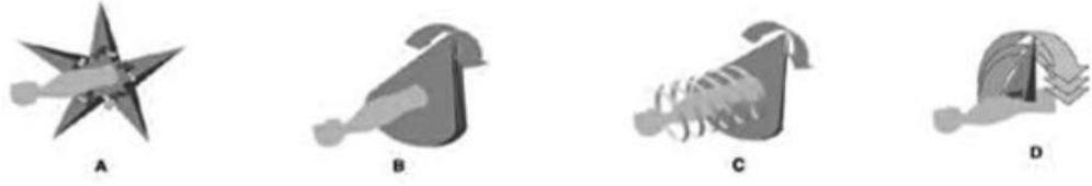
Şekil 2.5 A) Sabit Açılı IMRT B) Fan Beam IMRT C) Tomotherapy D) Cone Beam IMRT teknikleri için şematik çizimler
