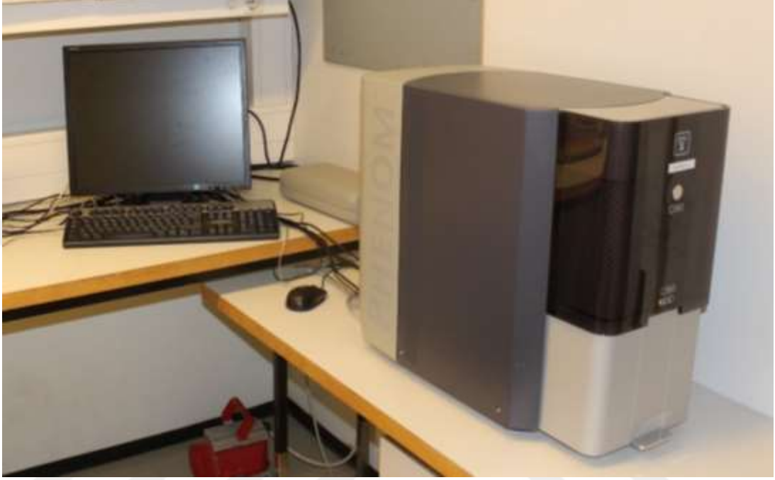
Resim 30: Çalışmada kullanılan Phenom ProX taramalı elektron mikroskobu.
