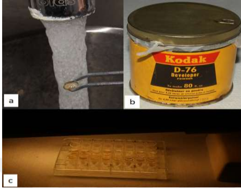
Resim-25: Gümüş iyonlarının metalik gümüşe indirgenmesi: a) Kesitlerin bol su ile yıkanması b) Fotoğraf geliştirme banyo tozu c) Kesitlerin karanlık ortamda floresans lamba altında bekletilmesi.
