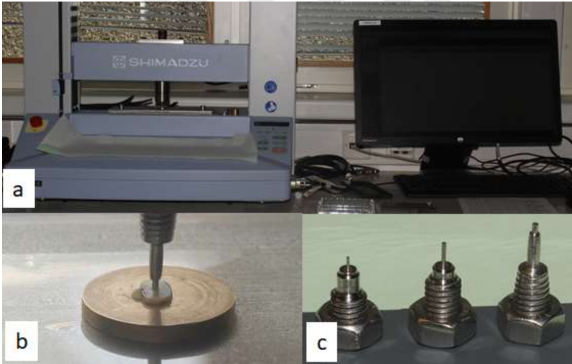
Resim-21: Mikro push-out test düzeneği: a) Kullanılan universal test cihazı b) Kuvvet uygulayıcı ucun kök kesidi ile pozisyonu c) Kesit bölgesine göre kullanılan 3 ayrı kuvvet uygulayıcı uç.
