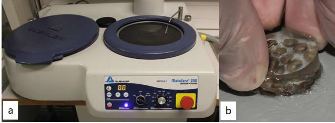
Resim-27: Epoksi plakaların parlatılması: a) Zımparalama ve parlatma cihazı b) Epoksi plakaların su soğutmasıyla parlatılması
