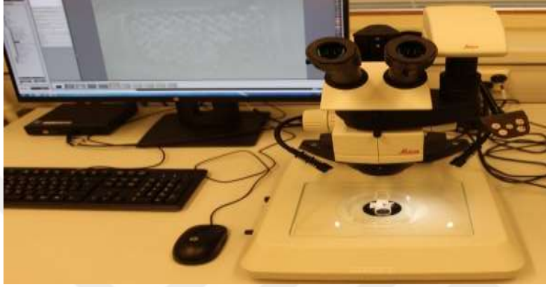
Resim-23: Ayrılma tiplerinin incelendiği stereomikroskop.
