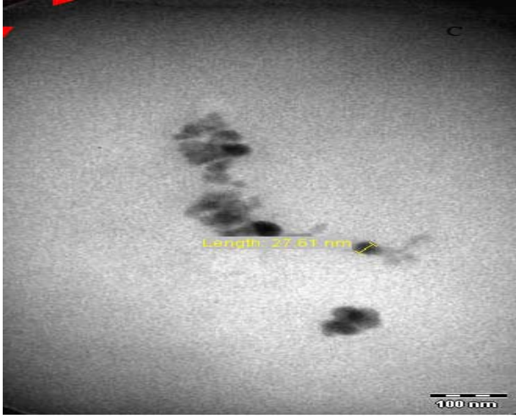
Şekil 3.46 (Devamı). CNT TEM görüntüleri A) CNT B) PS baskılı CNT C) LPA Baskılı CNT
