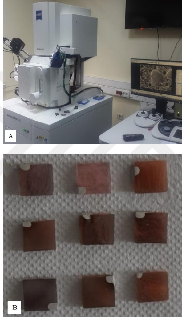
Resim 3. 13. A. Çalışmamızda kullanılan SEM cihazı; B. SEM incelemesi için altın-palladyum kaplanmış örnekler
