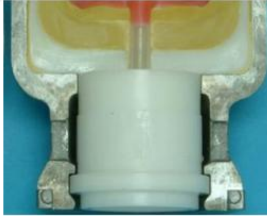
Resim 3. 3. Özel muflada oluşturulan enjeksiyon kanalı
