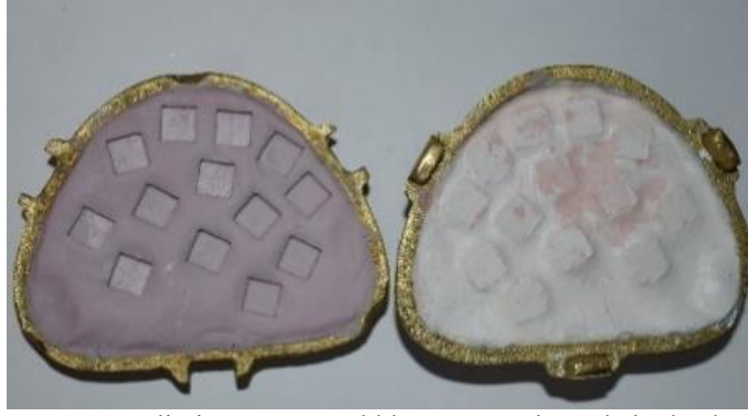
Resim 3. 2. Mum eliminasyonu yapıldıktan sonra oluşan kalıp boşluğu
