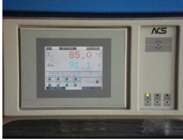
Şekil 5.17 İklimlendirme kabini sıcaklık-nem gösterimi
