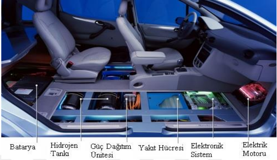
Şekil 2.4. Araç içerisinde Yakıt Hücresi Sistemi Gösterimi (NECAR5,2002)
