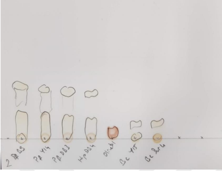
Şekil 3.15. N-hekzan-etil asetat (9:1) çözeltisi ile TLC’de yürütülen özütler. (Pf: P. furfuracea , Hp: H. pysodes , Bc: B. capillaris )
