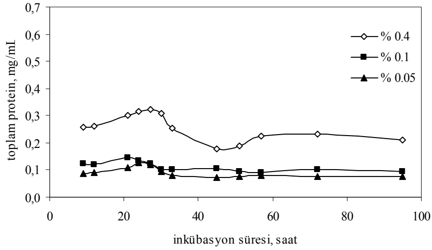
Şekil 5.38. Farklı konsantrasyonlarda pepton içeren fermantasyon ortamlarında protein konsantrasyonunun zamanla değişimi (% 1 mısır yağı, pH: 6, T: 30 °C, KH: 150 rpm, aşı oranı: % 10 v/v)
