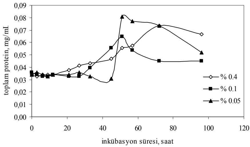
Şekil 5.46. Farklı konsantrasyonlarda amonyum dihidrojen fosfat içeren fermantasyon ortamlarında protein konsantrasyonunun zamanla değişimi (% 1 mısır yağı, pH: 6, T: 30 °C, KH: 150 rpm, aşı oranı: % 10 v/v)
