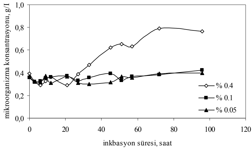
Şekil 5.45. Farklı amonyum dihidrojen fosfat konsantrasyonlarında mikroorganizma konsantrasyonunun zamanla değişimi (% 1 mısır yağı, pH: 6, T: 30 °C, KH: 150 rpm, aşı oranı: % 10 v/v)
