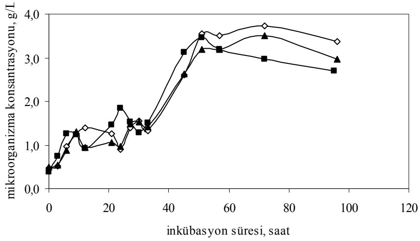
Şekil 5.49. Farklı fosfat konsantrasyonlarında mikroorganizma konsantrasyonunun zamanla değişimi (◇: % 0.025, ■: % 0.05, ▲: % 0.1 \text{KH}_2\text{PO}_4 ve \text{K}_2\text{HPO}_4 , % 1 mısır yağı, % 0.4 pepton, pH: 6, T: 30 °C, KH: 150 rpm, aşı oranı: % 10 v/v)
