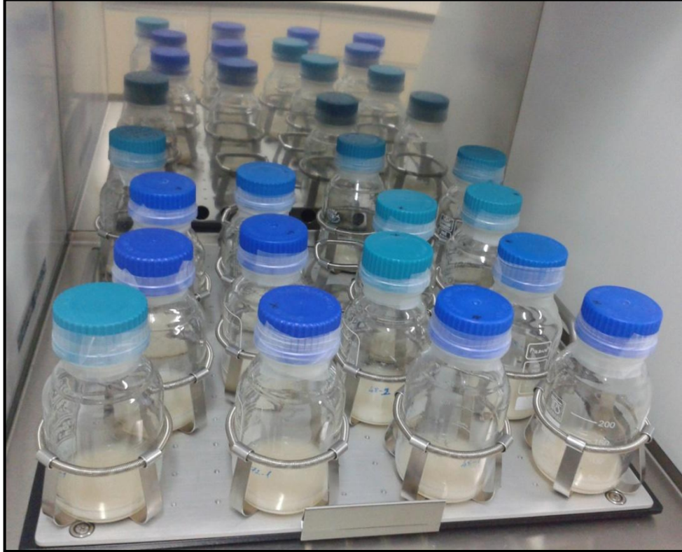
Şekil 3.6. Havalandırmasız ortamda gerçekleştirilen biyodönüşüm denemesi
