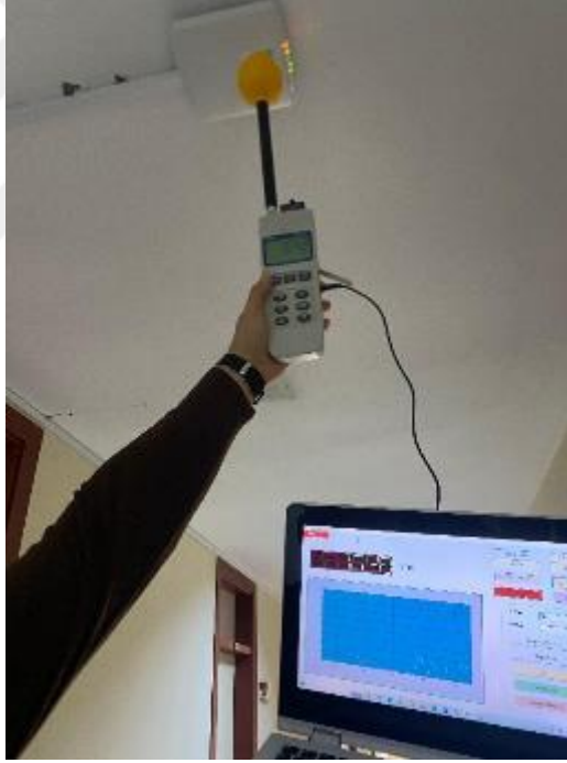
Şekil 12. Lutron marka EMA ölçer ve veri yakalama yazılımı
