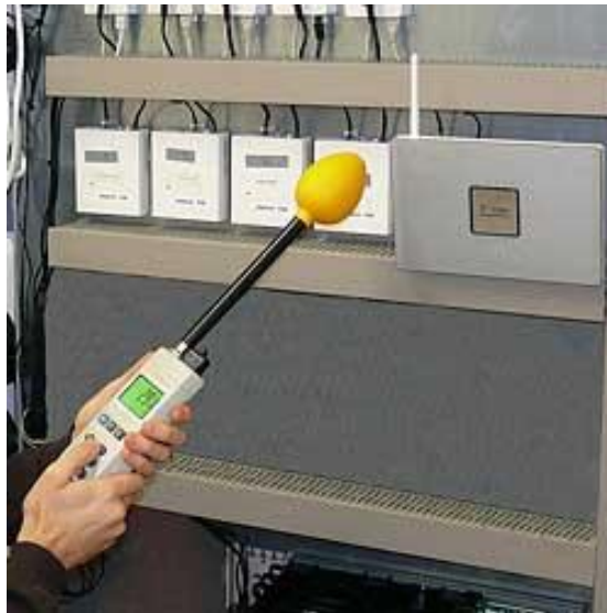
Şekil 11. Elektromanyetik alan ölçüm cihazı wireless LAN tespiti (PCE Instruments, 2024)
