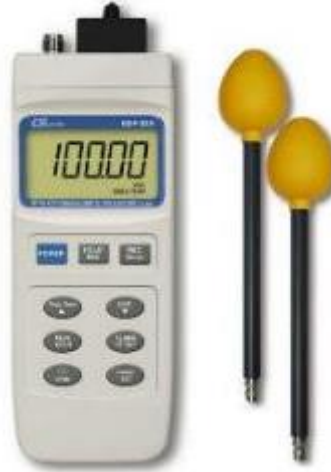
Şekil 7. Elektromanyetik alan ölçüm cihazı (PCE Instruments, 2024)
