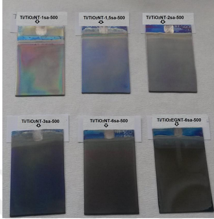
Resim 3.4 Farklı anodik yükseltgenme sürelerinde 0,15 M HF sulu çözeltisinde ve etilen glikollü ortamda (alt sağdaki) nanotüp yapısında elde edilip 500 °C’de kristallendirilen elektrotlar (Uygulanan yükseltgenme gerilimi: HF ortamında 20 V, etilen glikollü ortamda 40 V).
