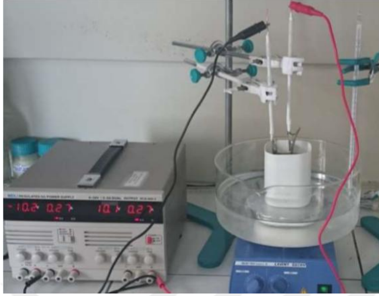
Resim 3.2 Anodik yükseltgenme işleminin uygulandığı iki elektrotlu sistem.
