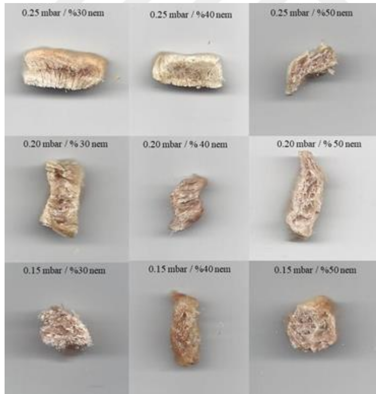
Şekil 4.11 Dondurarak ön kurutma ve ardından puf kurutma uygulanan örneklerin makro yapı görüntüleri
