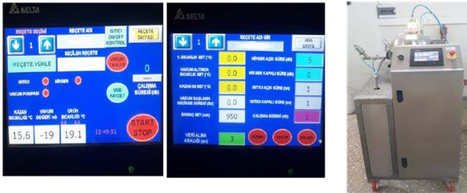
Şekil 3.3 Puf kurutma cihazı ve kullanıcı ekranı
