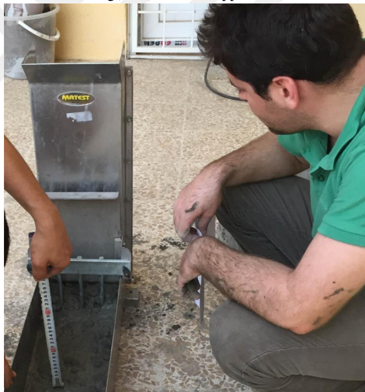
fig(3.13) b L-Box apparatus
