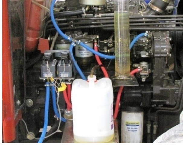
Şekil 5.10 Yakıt Sisteminin Kalibrasyonu
