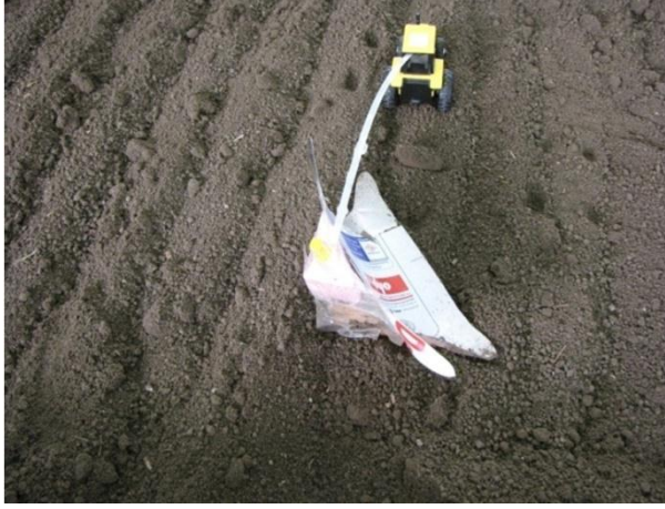
Şekil 2.1 ÇYP'nin %20 Ölçekli Modeli
