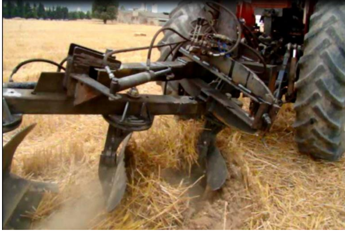
Şekil 4.30 Otomatik Çizi Ayar Mekanizmasının Tarlada Denemesi
