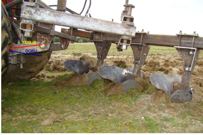
Şekil 4.18 ÇYP'nin Çalışırken Toprağa Batma Durumu
