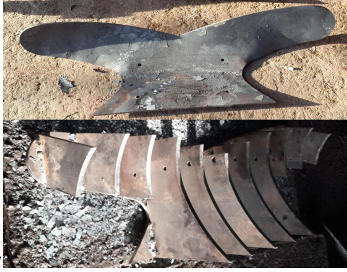
Şekil 4.36 Yeni Yapılan ÇYP Kalıp ve Gövde Yüzeyi
