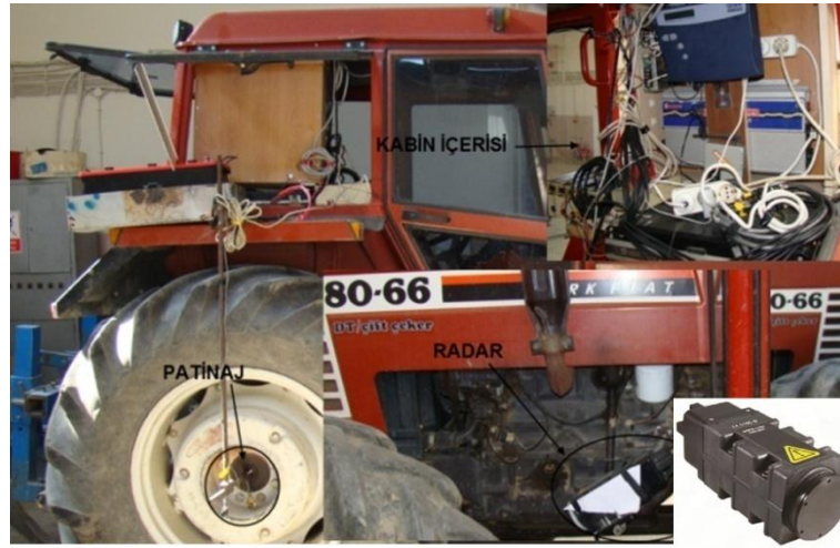
Şekil 5.13 Radar ve Patinaj Cihazların Traktör Üzeri Montajı
