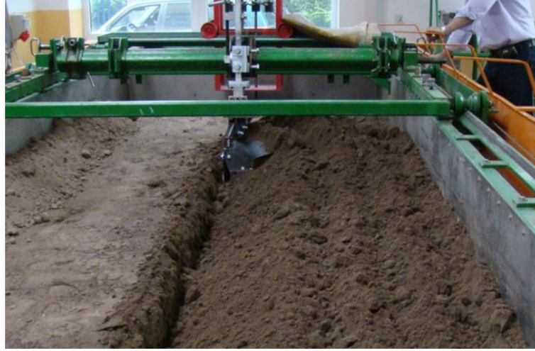
Şekil 3.4 ÇYP'nin Toprak Kanal Denemesi (Warsawa-Polonya -SGGW)
