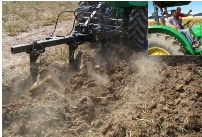
Şekil 4.33 ÇYP'nin 3. Çatı Döndürme Mekanizması ile Başarılı Ön Tarla Denemesi
