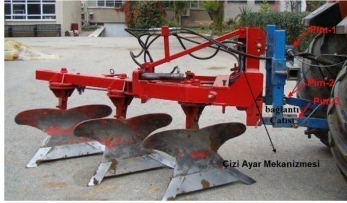
Şekil 4.32 Üç Nokta Askı Sistemi ve Hidrolik Silindirli Çizi Ayar Mekanizması
