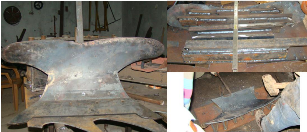
Şekil 4.7 Pulluk Kalp Yapımı ve 1:1 Prototip Gövde
