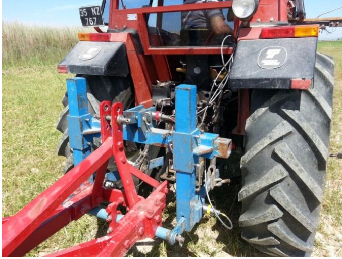
Şekil 5.9 Traktörün Üç Nokta Askı Sistemine Bağlı Çeki Kuvveti Ölçüm Sistemi
