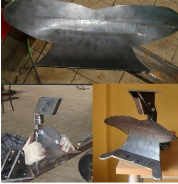
Şekil 3.2 Çift Yönlü Kulaklı Pulluğun %50 Ölçekli Modeli
