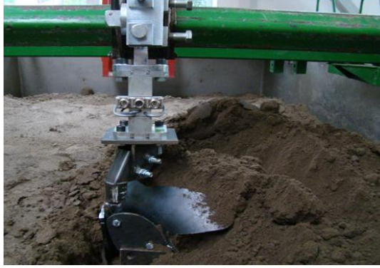
Şekil 3.7 Kuvvet Ölçer Kola Monte Edilmiş ÇYP %50 Modeli (Polonya -SGGW)
