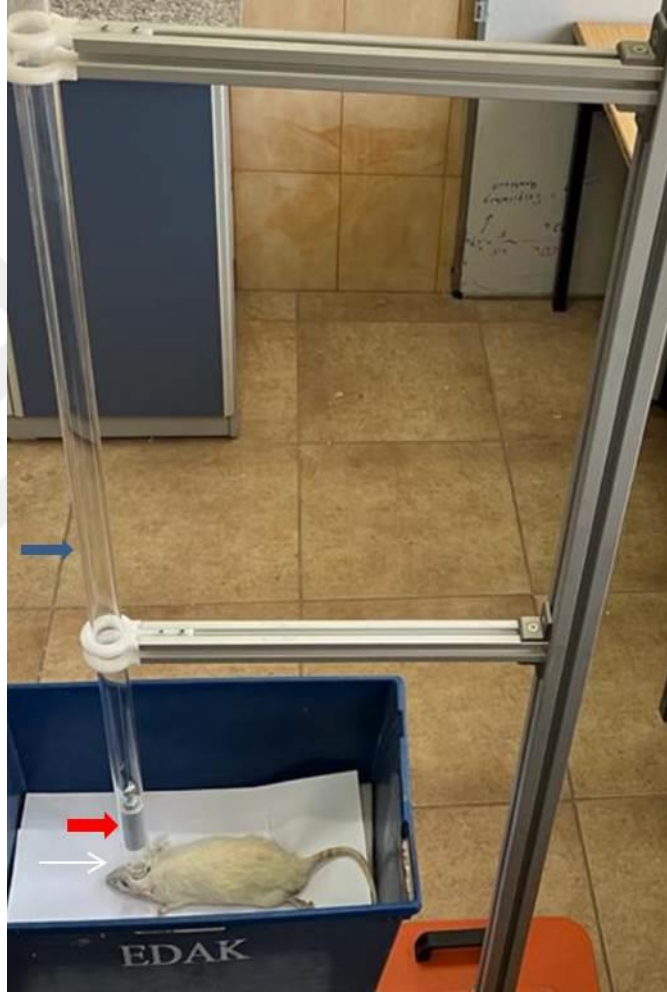
Şekil 3.2.1: Kafa travması çalışmamızda kullandığımız ağırlık düşürme sistemi. Mavi ok: İç çapı 20 mm, dış çapı 25 mm olan cam boru, Kırmızı ok:450 gr arasında değişkenlik gösteren çelik ağırlık, Beyaz ok: Kask olarak kullanılan 2 mm kalınlığında çelik disk.
