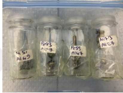
Resim 5.1 Kaplamada kullanılan intermetalik malzemeler.
