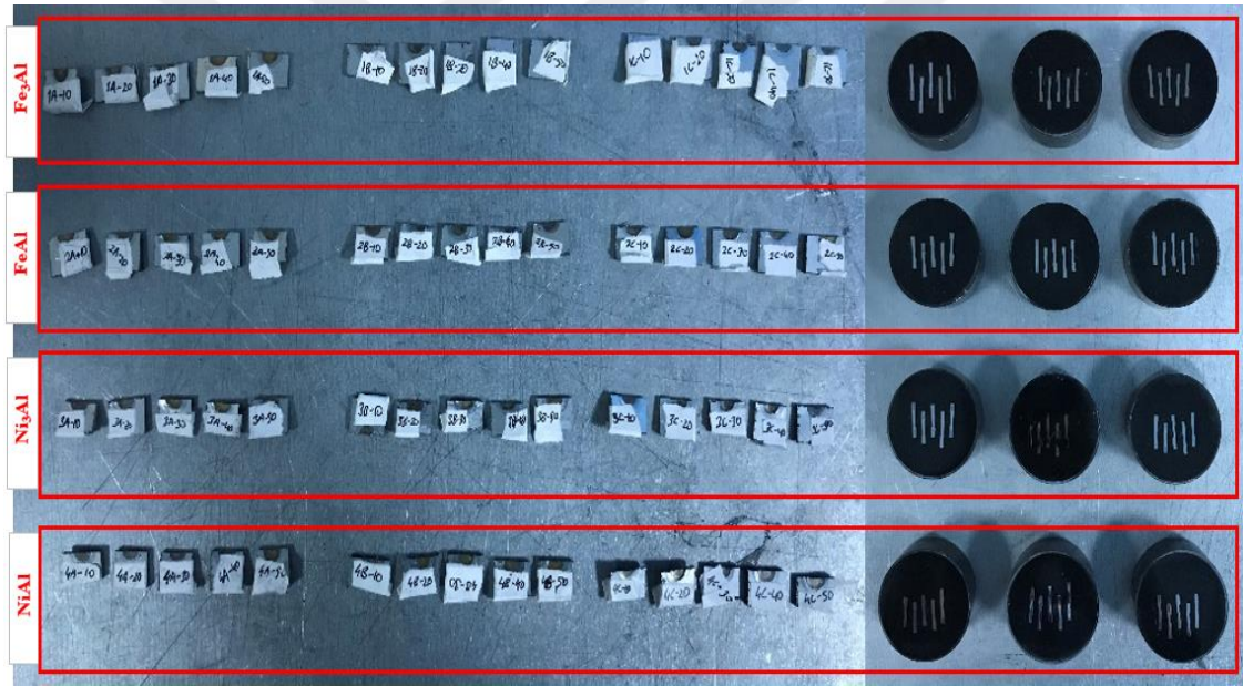
Resim 5.13 Kaplanmış kepler ile kaynaklanan metalografik numuneler.
