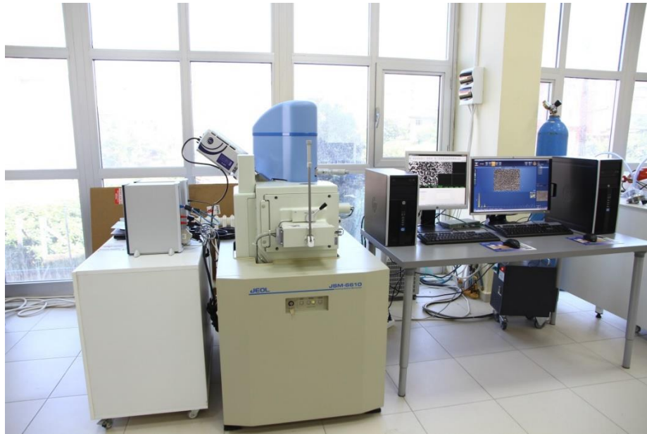
Şekil 38. JEOL marka JSM-6610 model taramalı elektron mikroskobu.
