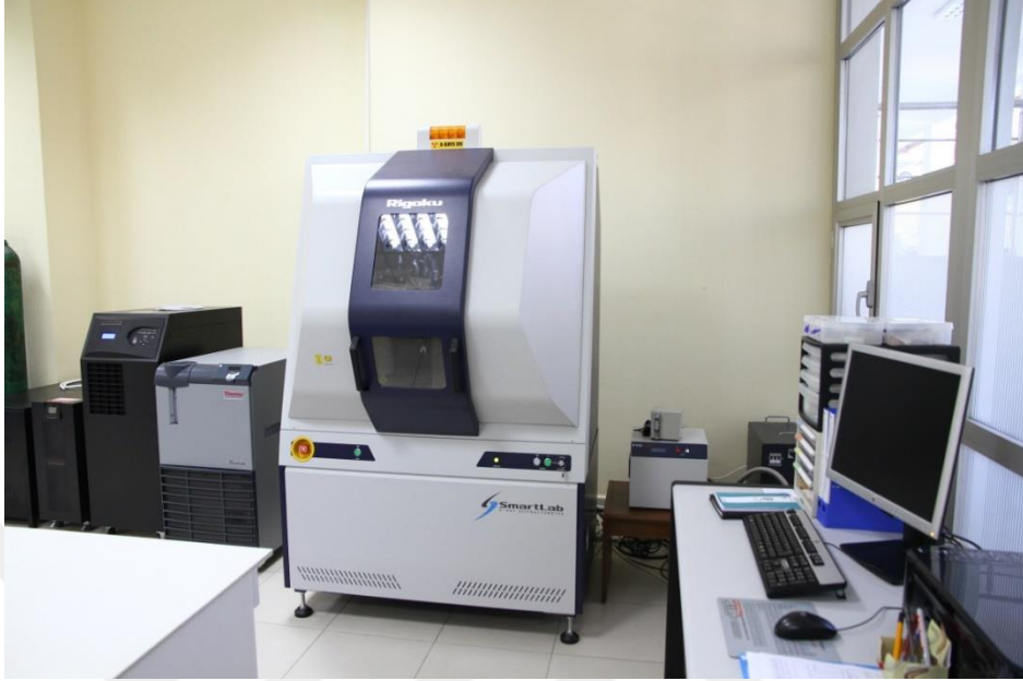
Şekil 37. Rigaku marka SmartLab X-ışını difraktometresi.
