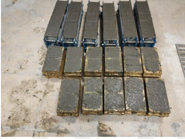
Resim 3.6. Priz alması için kalıpta bekletilen numuneler
