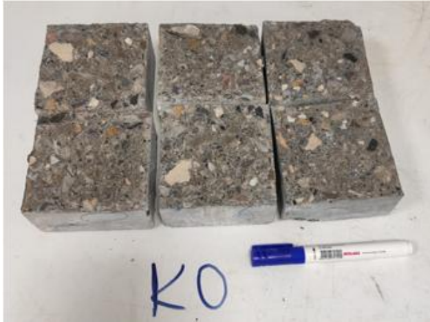
Resim 3.13. Yarmada çekme gerilmesine maruz kalan lifsiz beton numuneler
