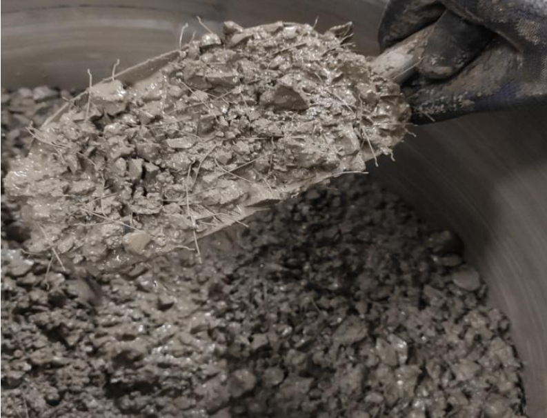
Resim 2.6. Taze betonda homojen dağılmış lifler
