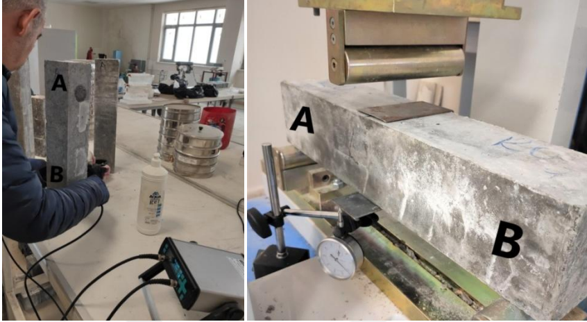
Resim 3.11. Uçları kodlanıp ses geçiş hızlarına bakılan kirişler
