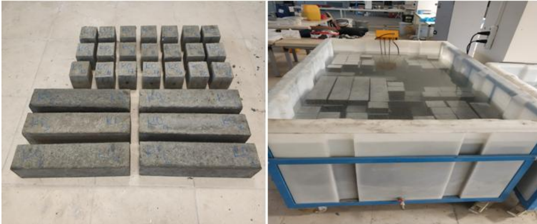
Resim 3.7. Kalıptan çıkartılarak kür havuzuna alınan numuneler
