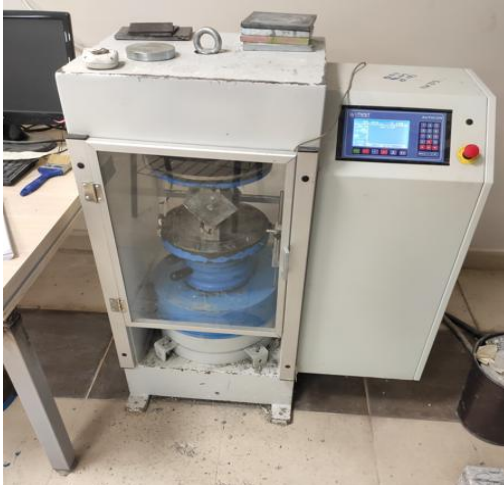
Resim 3.15. Diyagonal yarma deneyi düzeneği
