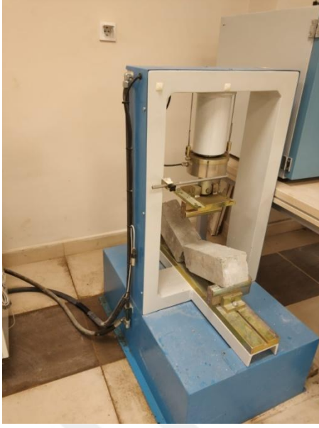
Resim 3.10. Üç noktadan yüklenen kiriş eğilme testi
