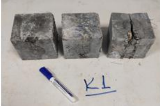
Resim 3.14. Yarmada çekme gerilmesine maruz kalan lifli beton numuneler
