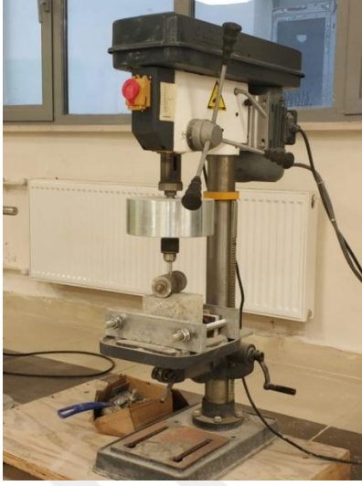
Resim 3.18. Rotating cutter yöntemiyle aşınma testi cihazı
