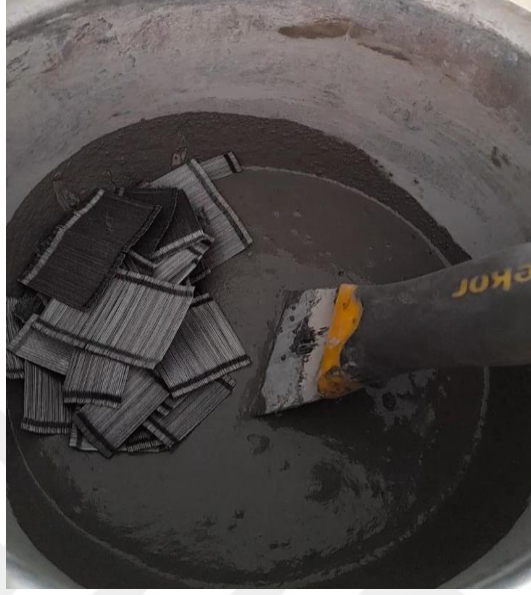
Resim 3.3 RPB serilerine karışım sırasında eklenen çelik lif.
